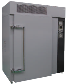
振動試験槽 設定可能温度：-30℃～+50℃ 温度範囲内でのプログラム 運転可能。庫内に振動試験機 を設置し、指定温度環境下での 振動試験機として製作
